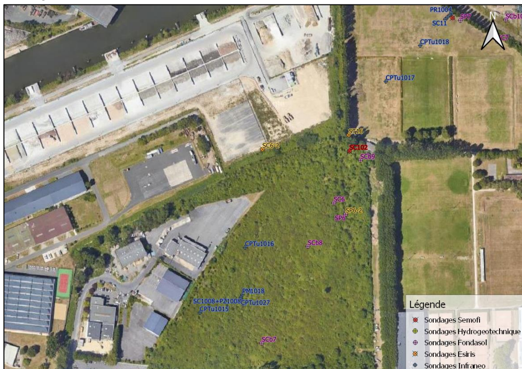
Figure 24 : Extrait du plan d'implantation des sondages au droit du secteur du giratoire intermédiaire (source : GINGER CEBTP)
