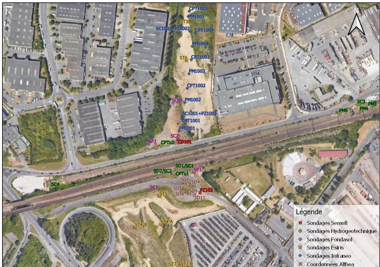
Figure 20 : Extrait du plan d'implantation des sondages au droit du secteur de la Trémie (source : GINGER CEBTP)
