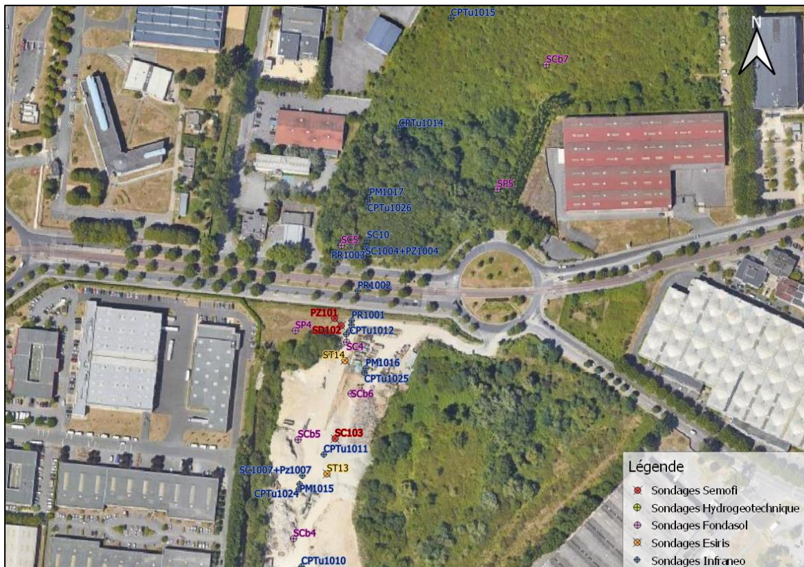
Figure 21 : Extrait du plan d'implantation des sondages au droit du secteur OA RD10 (source : GINGER CEBTP)
