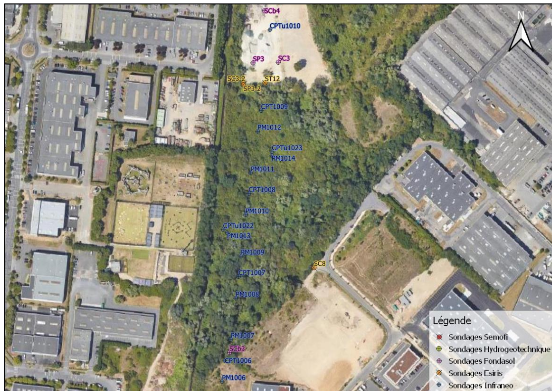
Figure 23 : Extrait du plan d'implantation des sondages au droit du secteur du giratoire sud (source : GINGER CEBTP)
